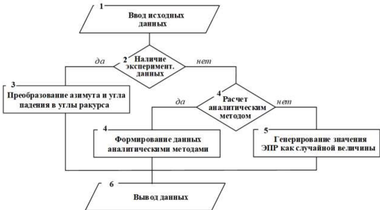
Рис. 3. Блок-схема алгоритма частной методики формирования экспериментальных (расчетных) данных
