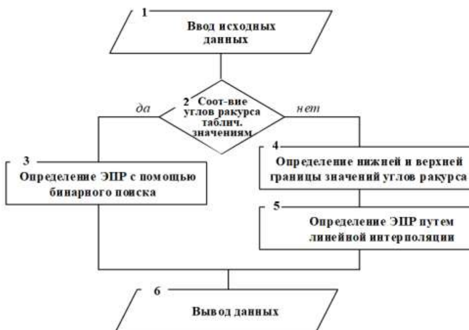
Рис. 4. Блок-схема алгоритма частной методики моделирования мгновенных значений отражательных характеристик
