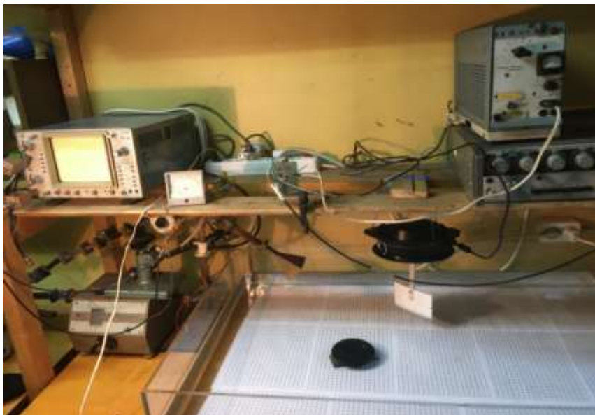
Рис. 1. Лабораторная установка, включающая в себя ванну, рупорную антенну локатора, лопатку приповерхностного вибратора и донный вибратор
