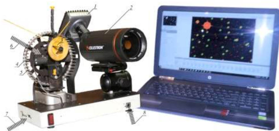
Рис. 6. Макет установки наблюдения за удаленными объектами с элементами калибровки
