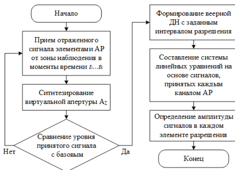
Рис. 4. Блок-схема алгоритма адаптивного синтеза апертуры приемной антенной решетки
