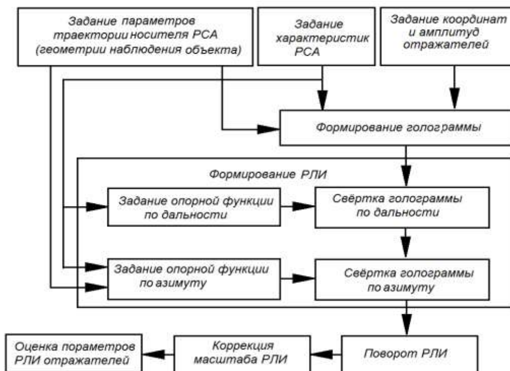
Рис. 6. Алгоритм имитационного моделирования
